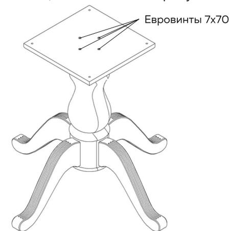
**5** Собранный стол присоединить к крышке с помощью винтов М6х35 и шайб, как показано на рисунке.
