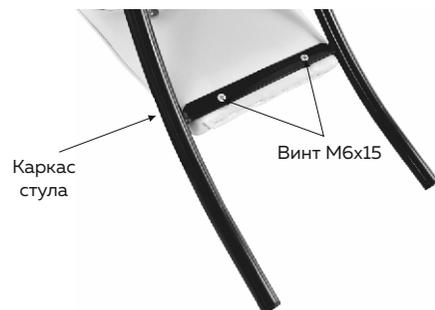
**5** Зафиксировать сиденье стула к каркасу наживив винты М6х35
