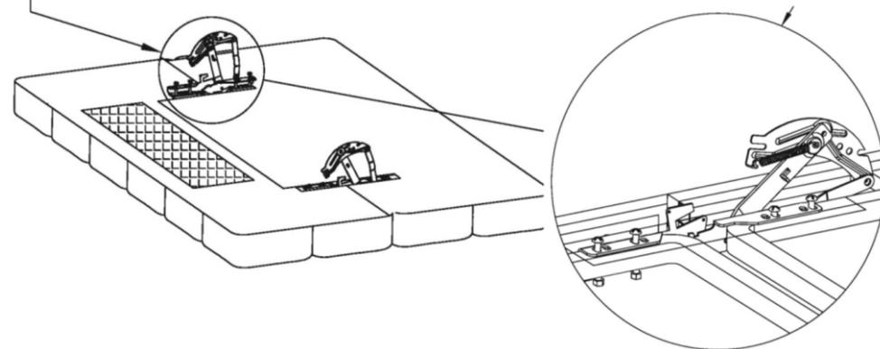
Каждый механизм имеет 4 пары отверстий. Для крепления к рамкам следует использовать внутренние (расположенные ближе к точке соединения)
