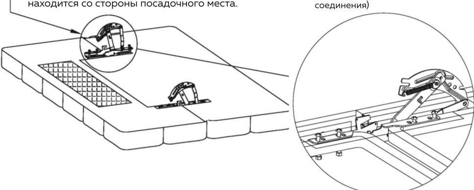
**4** Присоедините боковины к дивану с помощью болтов M8x120, Шайб M8 и Гаек M8
