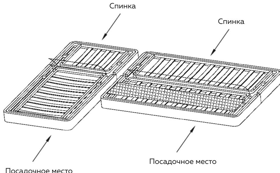
**3** Установка механизмов трансформации.
