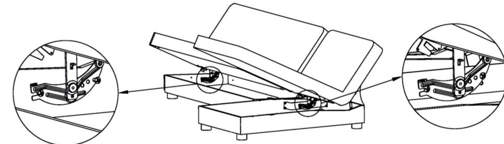
Обратите внимание. При установке механизма на угловой кронштейн, используется пара отверстий в кронштейне, расположенных по диагонали (верхнее заднее и нижнее переднее)
