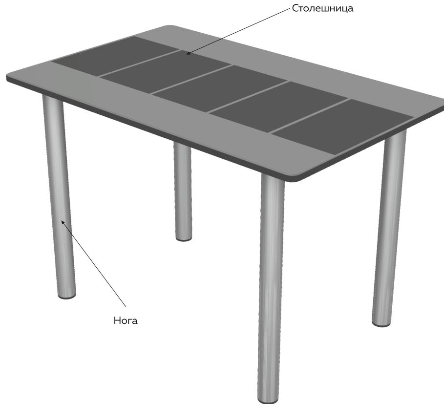
**2** На нижней стороне столешницы имеются центровочные отверстия для установки ног при помощи саморезов.
